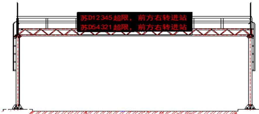
图 2 龙门架式情报板示意图
